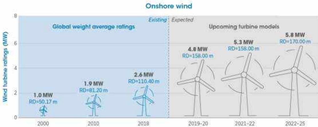
Figure 33 : évolution observée (2000-2018) et anticipée (2019-2025) de l'augmentation en hauteur, diamètre, et puissance des turbines (source : IRENA, 2019. Future of Wind)
